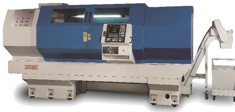
DIAMETRO DI VOLTEGGIO SUL BANCO 760 mm
